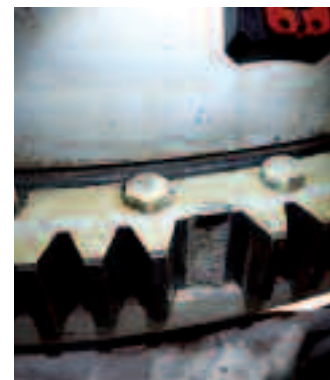
Dank der zerstörungsfreien Werkstoffprüfung ist der Fehler rechtzeitig entdeckt worden; der Zahnkranz hat (ähnlich wie beim Zahnarzt) neue Zähne erhalten.
